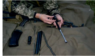
Іл. 19.9. Відокремлення затвора від затворної рами
