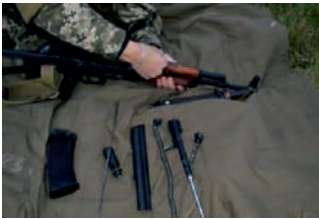
Іл. 19.10. Відокремлення газової трубки
