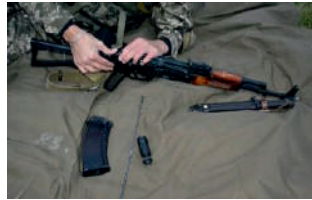
Іл. 19.6. Відокремлення кришки ствольної коробки
