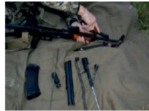
Іл. 19.10. Відокремлення газової трубки
