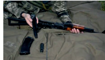
Іл. 19.6. Відокремлення кришки ствольної коробки
