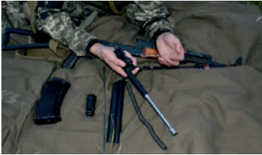
Іл. 19.9. Відокремлення затвора від затворної рами
